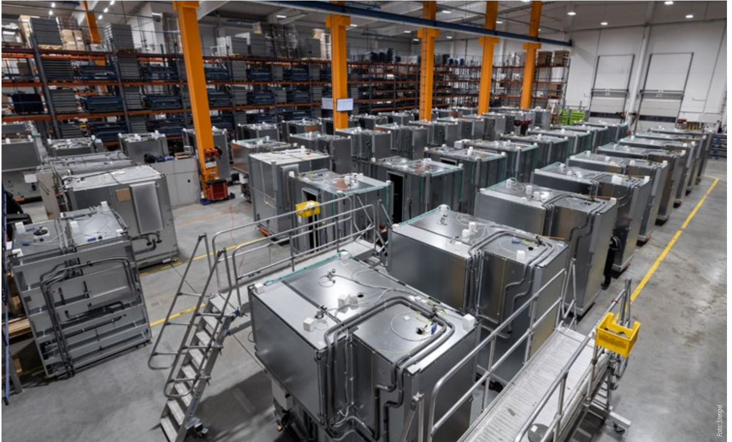
Im Trockenen und Warmen und mit hoher Qualitätskontrolle gefertigt: Fertigbäder für den Hochbau
