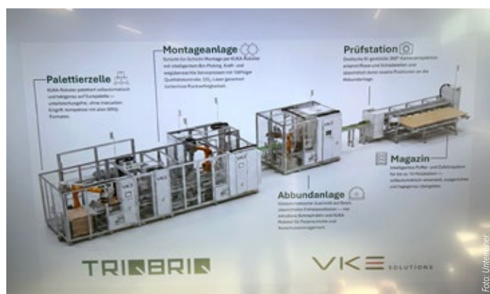
Vier Kuka-Roboter fertigen bis zu 100 000 Briqs im Jahr
